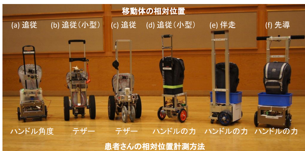
図5 様々な形態・入力インターフェースの試作機
